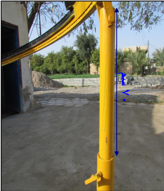
الشكل (٣) يوضح الركائز التي يرتكز عليها الجهاز المقترح
